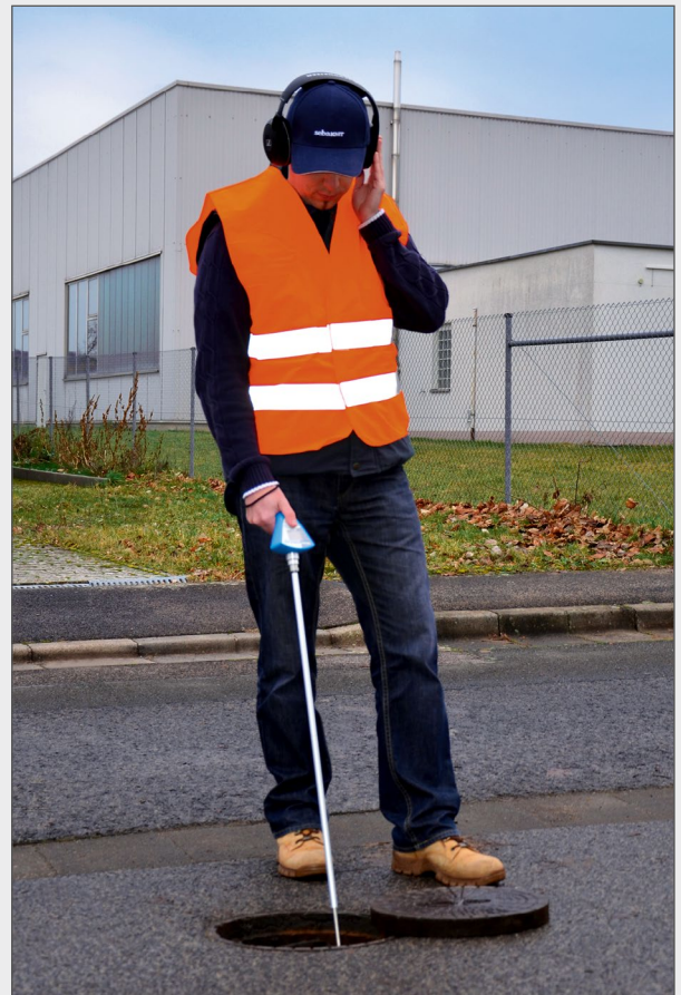
Punktortung mit HL 50 und PAM B-2 Universalmikrofon
