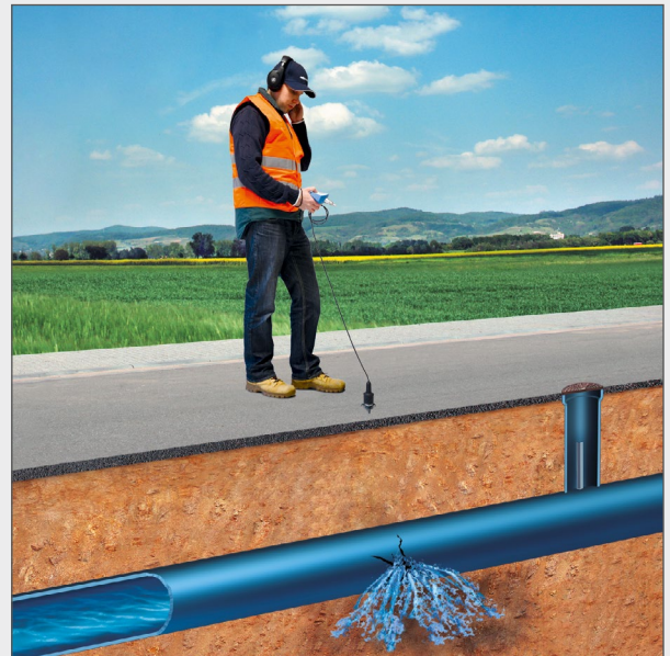
Punktortung mit HL 50 und PAM B-2 Universalmikrofon
