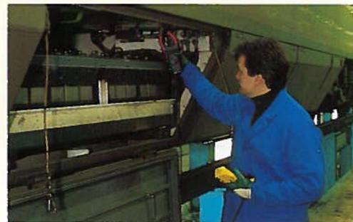
In der Eisenbahntechnik, im Bergbau, in der Chemie und in vielen anderen Industriebereichen sind sowohl hohe AC- als auch DC-Ströme zu messen. Hierfür ist die PAC 21 - Zange besonders geeignet. Von mittleren Stromstärken bei Batterie-Stromnetzen bis zu hohen Anlaufströmen an DC-Motoren (Anlasser, Förderbänder usw...).
