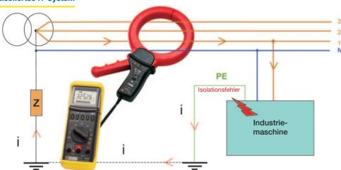
Der robuste und anwenderfreundliche Mehrbereichs-Zangenstromwandler B102 mit Spannungsausgang ist für den Anschluss an allen Multimetern oder Schreibern geeignet. Er führt vorbeugende Messungen durch, um Isolationsfehler festzustellen und zu beheben. Er ist ein ideales Werkzeug um die Konformität elektrischer Anlagen im Rahmen der Normen DIN VDE 0100, NIN/NIV, ÖVE E 8001 und IEC 60304 zu überprüfen. Die Messungen können an verschiedenen
