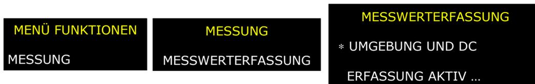
In einem zweiten Schritt nehmen Sie nun die Messungen am Wechselrichter vor. Entfernen Sie die Anschlüsse am Solarpanel und lassen Sie das GREENTEST FTV100-Prüfgerät eingeschaltet, um die AC-Messungen am Wechselrichter bzw. Inverter vorzunehmen.
