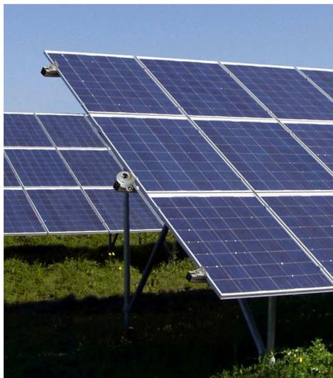
Beispiel für die Aufstellung des Pyranometers
