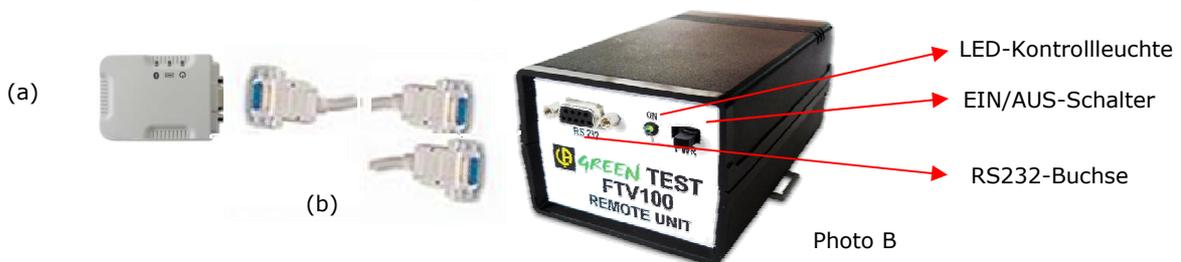
3. Schließen Sie den zweiten Bluetooth-Adapter (Schalter des Adapters auf Position "Pori" stellen) oder das RS232-Kabel mit seinem Stecker an die entsprechende Buchse des GREENTEST-Prüfgeräts an.
