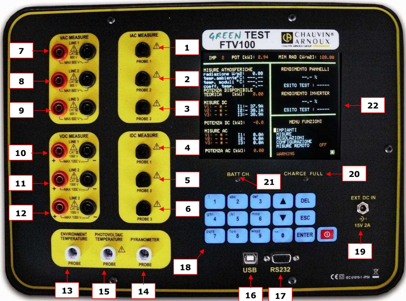
1. Eingang 1 : A<sub>AC</sub>-Strommesszange
