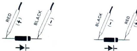
Wenn die Prüflleitungen wie in Abb. 2 zu sehen angelegt werden, wird eine Rückwärtsmessung der Diode durchgeführt. Wenn die Diode heil ist, wird ein „OL“ angezeigt. Wenn die Diode defekt ist, erscheint eine „.0000“ im Display. Bei einer Diodenmessung sollten immer beide Prüfwege benutzt werden.
