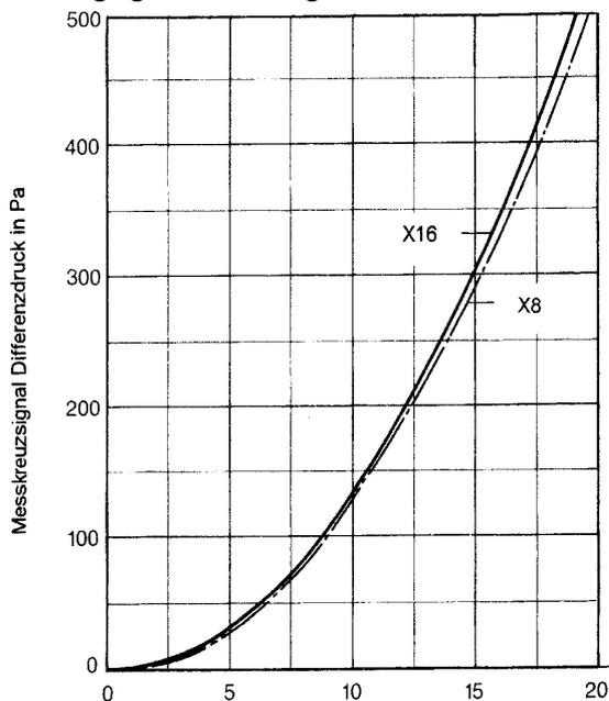
Mittlere Strömungsgeschwindigkeit in m/s
