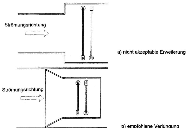
Abbildung 2 - Veränderung des Kanalquerschnitts an der Messstelle
