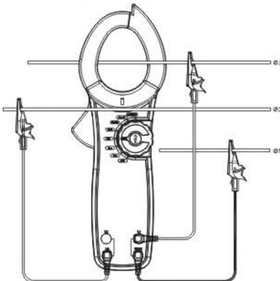
1. Halten Sie „SEL“ für fünf Sekunden gedrückt, damit in den 3P3W-Modus umgeschaltet wird. Im Display erscheint 3Ø3W.
