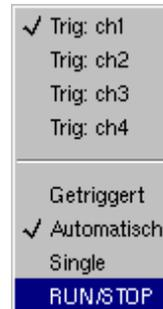
RUN/STOP startet und stoppt die Erfassung ausgehend von diesem Menü. Der Status einer Erfassung wird im Statusbereich des Displays angezeigt.
