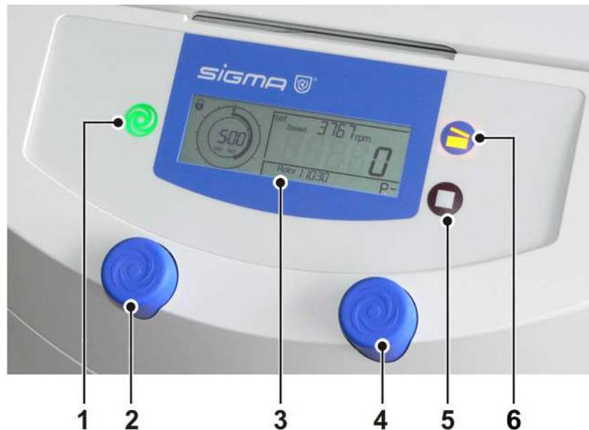
Abb. 9: Bedienoberfläche der Steuerung "Spincontrol Easy"
