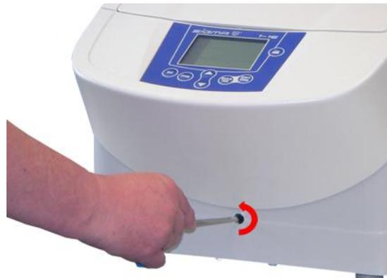
Abb. 11: Manuelle Entriegelung des Deckelschlosses
