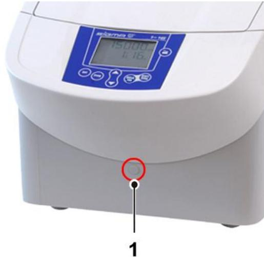
Abb. 10: Position der Öffnung für die Notentriegelung
