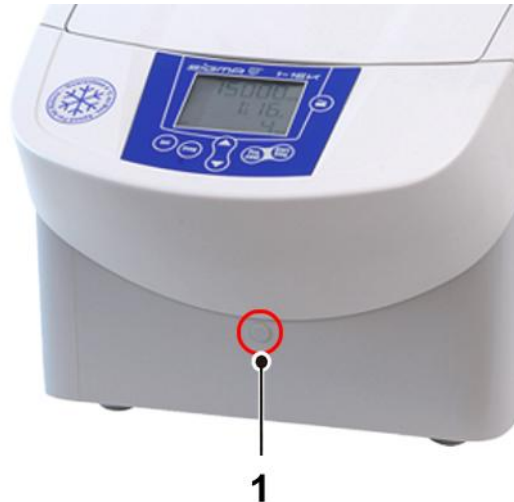
Abb. 10: Position der Öffnung für die Notentriegelung
