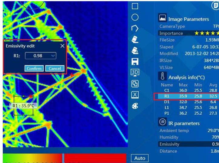
Falls der Emissionswert aller Analysetools geändert werden soll, muss der Benutzer in den Infraroteinstellungen doppelt auf Emissionswert klicken und daraufhin diesen entsprechend ändern und speichern.
