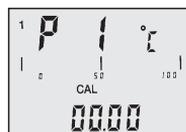
**Wichtig:** Ein Abbruch der physikalischen Kalibrierung **oP2** kann nicht mit der ESC-Taste durchgeführt werden. Der gewünschte Kalibrierabbruch geschieht durch das Abschalten des Messgerätes.
