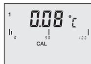
Die kleine 1 in der linken Ecke in Verbindung mit dem Anzeigesegment **CAL** in der Displaymitte zeigt Ihnen an dass die Nummernkalibrierung **oP1** aktiviert wurde.
