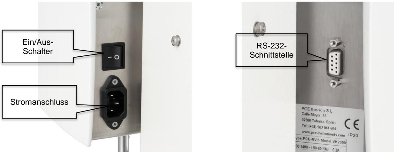
Der Ein/Aus-Schalter, der Stromanschluss und die RS-232-Schnittstelle befinden sich auf der Rückseite des Viskosimeters.
