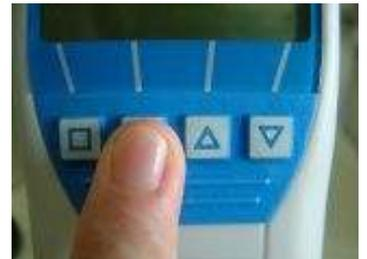
3.) Mit Hilfe der beiden Pfeiltasten können die Kennlinien gewechselt werden.
