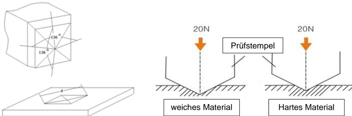
Während des Messvorgangs dringt der Prüfstempel der Messsonde nur minimal in das Material ein:
