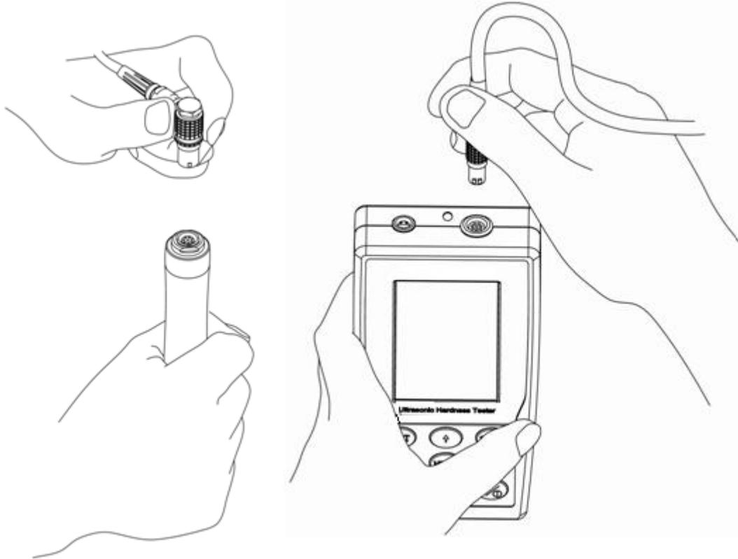
2. Stecken Sie als nächstes den Stecker am anderen Ende des Sensorkabels in die 8-Pin-Buchse an der Oberseite des Messgerätes. Orientieren Sie sich wieder an den Markierungen an Stecker und Buchse. Ist der Stecker korrekt eingesteckt, hören Sie ein Klick-Geräusch.
