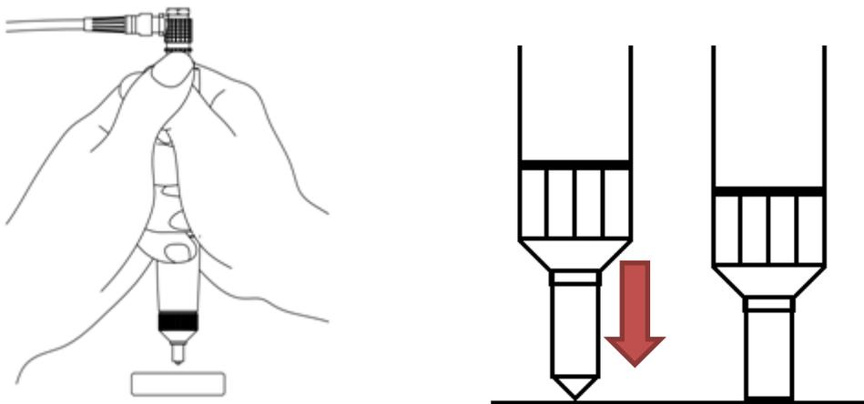
4. Nach ca. 2 Sekunden ertönt ein Piep-Ton. Dies bedeutet, dass die Messung erfolgreich war. Heben Sie nun die Messsonde von der Oberfläche des Testobjektes ab und wiederholen Sie anschließend Schritt 3. Führen Sie so insgesamt 5 Messungen durch. Durch Drücken der Enter-Taste können Sie die letzte Einzelmessung der Messreihe löschen. Sobald Sie 5 Einzelmessungen durchgeführt haben, werden Ihnen die Ergebnisse der Messreihe angezeigt:
