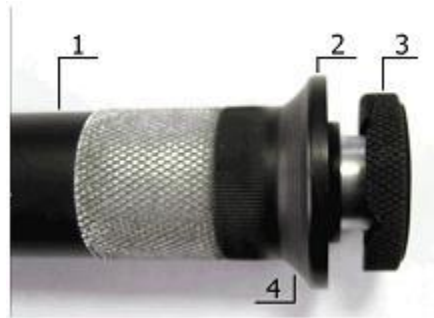
Abbildung 1a. UCI Tester U1 1 – Körper des Testers; 2 – Zusammenklappbare Düse; 3 – Puck; 4 – Platz für die Finger
