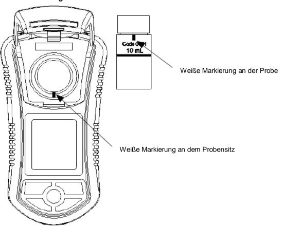
An der oberen Kante der Probenflasche und an der oberen Kante des Probensitzes befindet sich jeweils eine weiße Markierung. Stecken Sie die Probenflasche in der Probensitz komplett rein, sodass die beiden Markierungen fluchten. Bevor Sie mit der Messung beginnen, schließen Sie den Schutzdeckel der Probe.
