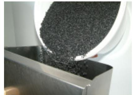
5. Das Prüfmittel muss nun komplett eben gestrichen werden. Es darf dabei aber kein Material komprimiert werden.
