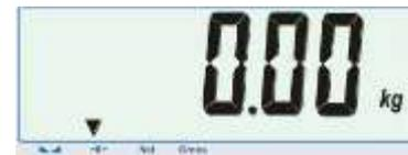
Sollte bei nicht geeichten Waagen nach dem Start kein Nullwert „0,0 g“ angezeigt werden so ist der Aufbau und Aufstellungsort der Waage zu prüfen.
