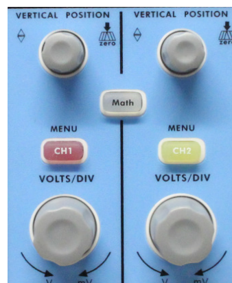
Abb. 10 Bedienelemente für Vertikalsteuerung
