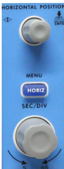
Abb. 11 Bedienelemente für Horizontalsteuerung
