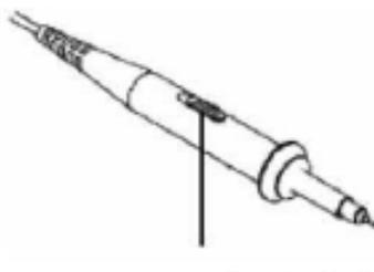
**Abb. 10** Dämpfungsschalter
