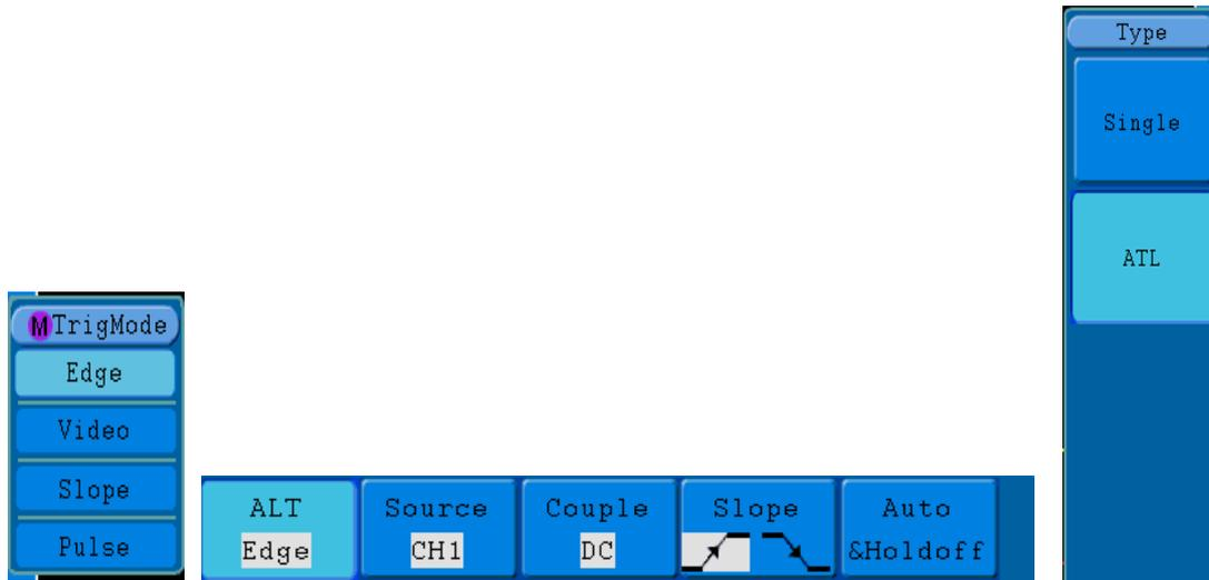
**Abb.34** Menü für alternierenden Trigger (ALT) (Triggertyp: Edge)
