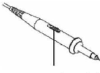
**Fig. 10** Attenuation Switch
