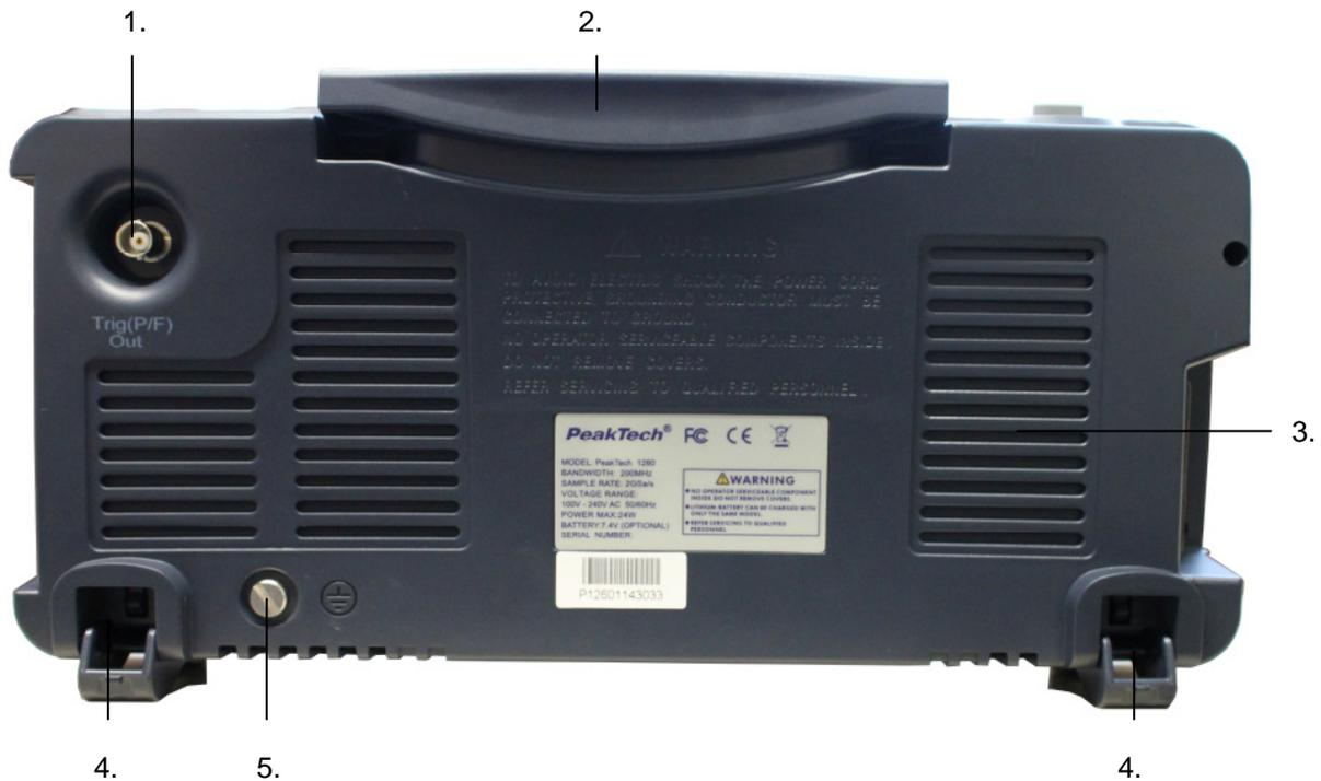
**Abb. 4** Rückseite des Oszilloskops
