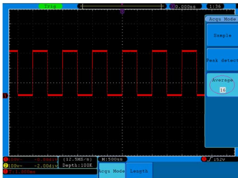
Abb. 83 Reduzierter Rauschpegel durch Verwenden der Average-Funktion
