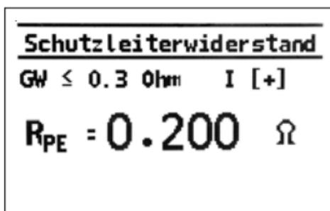
Bei erneuten Tastendruck wird die Messung mit vertauschter Polarität des Prüfstromes fortgesetzt. Durch weiteren Tastendruck wird die Messung des Schutzleiterwiderstandes beendet und der weitere Messablauf durchgeführt.
