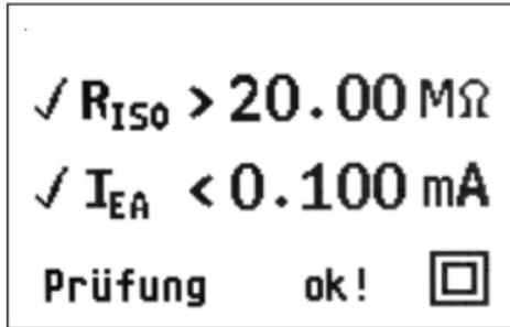
Durch kurzes Betätigen der „START“-Taste kann die Prüfung wiederholt bzw. nach Anschluss eines weiteren Prüflings eine neue Prüfung durchgeführt werden.
