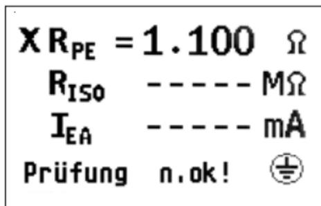
Bei der Schutzleiterwiderstandsmessung kann der automatische Prüfablauf auch als Dauermessung (max. 3 min) umgeschaltet werden.
