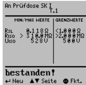
Hier können Sie die Messergebnisse der aktuellen Prüfung speichern, die aktuelle Prüfung in die entsprechende Protokollvorlage drucken, eine der bereits gespeicherten Prüfungen aufrufen (blättern: Option DBmed, siehe Kap. 12) sowie sämtliche gespeicherte Messergebnisse ausdrucken.
