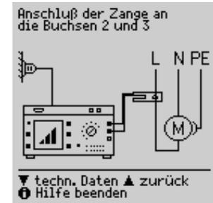
Mit einem an die Buchsen N (2) und L (3) angeschlossenen Zangen-Strom-/Spannungswandler z.B. WZ12C können in zwei Messbereichen (1 mA ... 10 A ~, 1 A ... 100 A~) Wechselströme gemessen werden.
