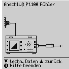
Mit einem Pt100- oder Pt1000-Fühler (Grundeinstellung), der an die Buchsen SL (1) und N (2) angeschlossen ist, können Temperaturen im Bereich  $-200\text{ °C} \dots +850\text{ °C}$  gemessen werden.
