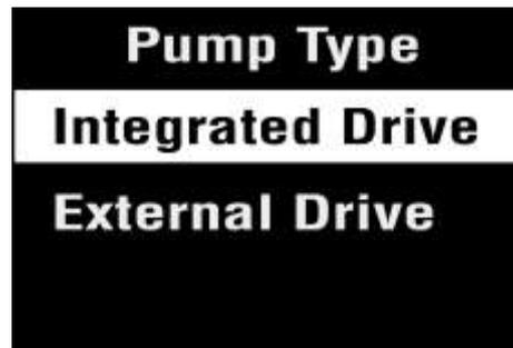
Die Auswahl des Maschinentyps und -größe führt dazu, dass die ISO Grenzwerte automatisch dementsprechend gesetzt. Selbiges geschieht durch die Auswahl des Befestigungstypes („Mounting Type“ mit den Optionen flexibel („flexible“) und starr („rigid“)).
