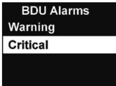
Durch die Auswahl von „BDU Alarms“ können Sie die Wertebereiche bei denen die Farbe des Hintergrund geändert wird ändern. Die normalen, unbedenklichen Werte werden vor einem grünen Hintergrund dargestellt.
