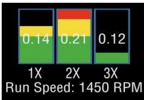
**HINWEIS: Zwecks Vibrationsanalyse ist es wichtig, dass die Maschinenlaufgeschwindigkeit korrekt eingegeben wird. Dies geschieht über den Setup Assistenten in Kapitel 6.3.1 oder mittels Stroboskop Zusatzgerät (Kapitel 9.1).**
