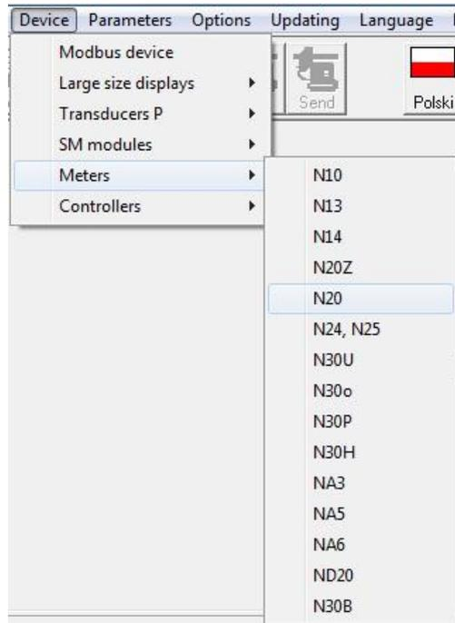
Sobald diese Auswahl getätigt wurde, versucht die Software sich mit der Anzeige zu verbinden. Sollte es zu einer Fehlermeldung kommen, überprüfen Sie die Verbindung **Anzeige** → **PCE-PD 14** → **LPCon**. Sollte es immer noch zu einer Fehlermeldung kommen überprüfen Sie die Kommunikationsparameter (s.2.4.2.1).
