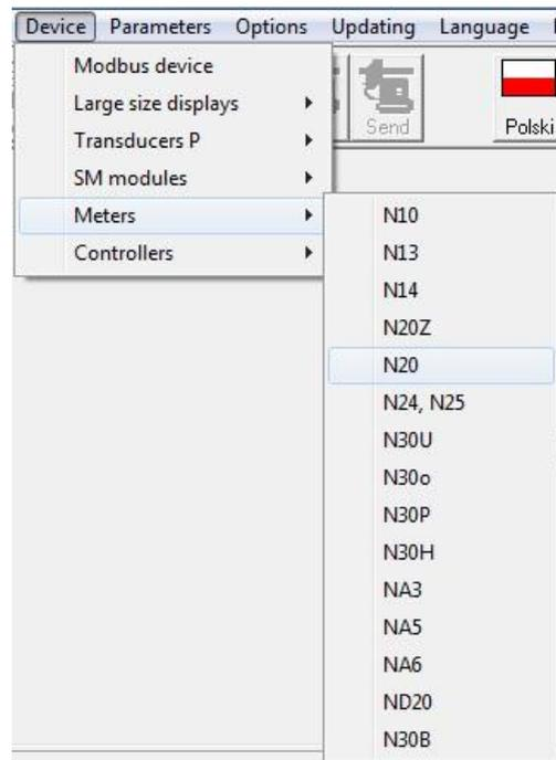
Sobald diese Auswahl getätigt wurde, versucht die Software sich mit der Anzeige zu verbinden. Sollte es zu einer Fehlermeldung kommen, überprüfen Sie die Verbindung **Anzeige** → **PCE-PD 14** → **LPCon**. Sollte es immer noch zu einer Fehlermeldung kommen überprüfen Sie die Kommunikationsparameter (s.3.4.2.1).
