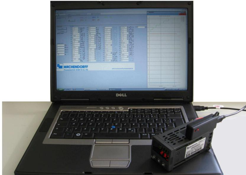
**Bild 1: Wachendorff-Regler Software mit Programmiermodul**
