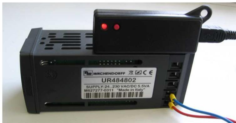
Bild 3: Installation Programmiermodul im UR4848xx
