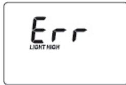
**Light High (Zuviel Licht):** für eine Messung ist zuviel Licht vorhanden. Bitte überprüfen Sie die Blindprobenküvette.
