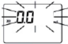
**Unter dem Messbereich:** die blinkende Anzeige "0.00" weist darauf hin, dass die Probe weniger Licht als die Blindprobe absorbiert. Überprüfen Sie den Vorgang und stellen Sie sicher, dass für Nullabgleich und Messung ein- und dieselbe Küvette verwendet wird.
