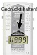
Der Taster „Batt. Check“ dient zur Überprüfung des Ladezustands (je mehr Segmente im Display schwarz werden, desto voller der Akku).
