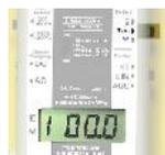
Feldwahlschalter auf „Test“. In der Anzeige erscheint links senkrechter Balken als Zeichen für den Test-Modus. Die Zahl zeigt die momentane Nullpunktabweichung. Um diesen Wert erhöht sich die Toleranz des Messergebnisses.
