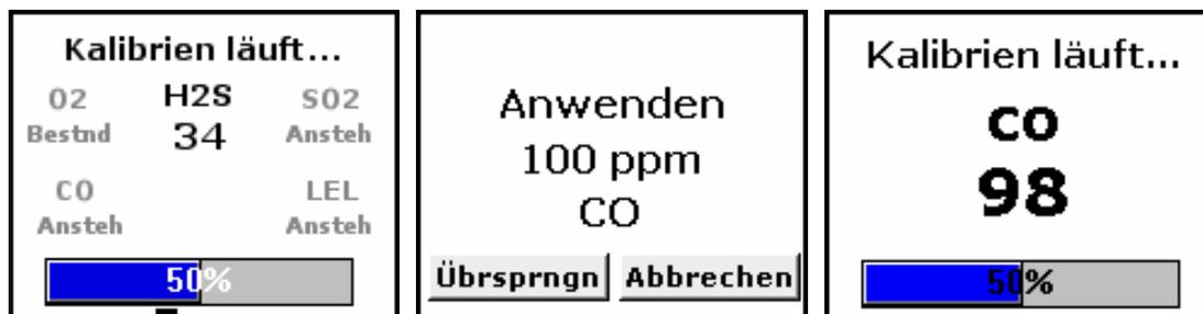
Nach Abschluss der Kalibrierung gibt die folgende Anzeige für alle sechs Sensoren das Ergebnis der Kalibrierung als bestanden (Bestnd), grenzwertig (Grnzwr), übersprungen (Übrspr) oder fehlgeschlagen (Fhlgsch) an. Damit ein Sensor die Kalibrierung besteht, muss er zuerst die Nullpunktprüfung bestehen.
