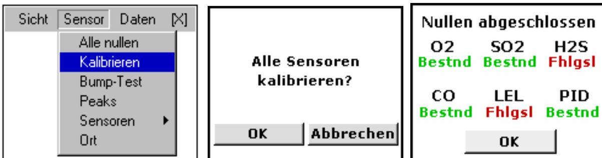
Dabei zeigt das Gerät eine Aufforderung an, Gas an das Gerät zu leiten. Die Kalibrierung beginnt, sobald der Sensor das Gas misst. Das Gas muss innerhalb von 5 Minuten zugeführt werden, anderenfalls erfolgt ein Timeout. Der Gasdurchfluss sollte 0,5 l/min betragen. Wenn die Kalibrierung eines Sensors übersprungen wird, fährt das Gerät mit dem nächsten Sensor fort. Die Schaltfläche „Abbrechen“ bricht die Kalibrierung ab und führt zur Anzeige „Kal fertig“.
