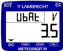
Im Anschluss sehen Sie im Hauptfeld den Messwert mit Dimension, im Funktionsfeld wird die Messstelle angezeigt. Alle möglichen besonderen Betriebszustände des Messwertes werden in 8.4 erläutert.
