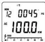
Drücken Sie die Taste **SELECT** bis Ø1 im Display erscheint. Drücken Sie die Taste **MENU** bis KW / PG im Display erscheint.
