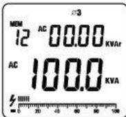
Zur Messung der Phase 3 drücken Sie die Taste **SELECT** bis Ø3 im Display erscheint.
