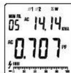
Drücken Sie die Taste **SELECT** zweimal sodass Ø1, Ø2, und ΣW im Display erscheint. Es wird die Leistungssumme der zwei Phasen angezeigt. Die Tasten **MAX▲** oder **MIN▼** schalten zwischen Leistung / Blindleistung und Leistungsfaktor / Scheinleistung um.
