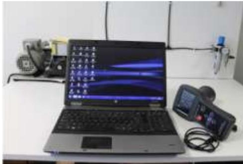
Verbinden Sie das USB-Kabel mit dem PC und dem ausgeschalteten Leckage-Prüfgerät PCE-LDC 2:
