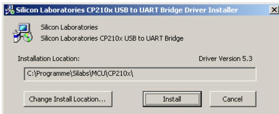
Klicken Sie anschließend auf „Install“ um den Treiber zu installieren.
