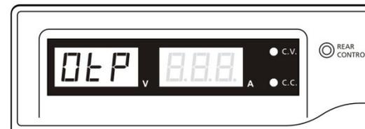
Überprüfen Sie die Last und die Ausgangsleistung. Lassen Sie das Gerät mindestens 30 Minuten abkühlen. Prüfen Sie, ob die Lüftung blockiert ist und genug Raum um das Netzgerät ist.
