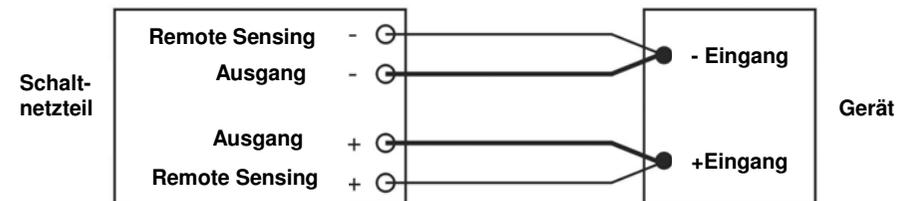
Die Remote Sensing-Leitung sollte mindestens 22 AWG (0,64 mm<sup>2</sup>) sein.
