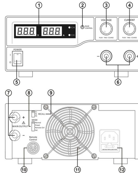
1. LED-Anzeige für Strom und Spannung mit CC/CV-Anzeigen
