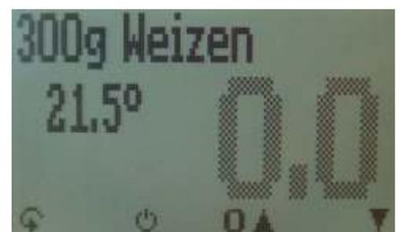
6. Den Becher mit **der richtigen Menge an Material** (+/1,0 g) befüllen. Die Befüllmenge wird links oben am Display des humimeter Gerätes angezeigt.
