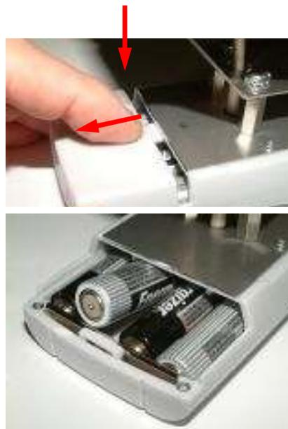
Erscheint das Batteriesymbol im Messfenster bzw. wird im Statusfenster kritischer Ladezustand angezeigt, sind UNVERZÜGLICH die Batterien zu wechseln. Auch wenn das humimeter Gerät für längere Zeit nicht gebraucht wird, sind die Batterien aus dem Gerät zu entfernen. Für ggf daraus resultierende Schäden gibt es keine Garantieansprüche.
