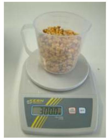
7. Das Messgerät mit dem Messgut **langsam und gleichmäßig befüllen**. Dadurch ergeben sich reproduzierbare Messwerte. Für das Befüllen des Messgerätes darf kein Trichter oder ähnliches verwendet werden.
