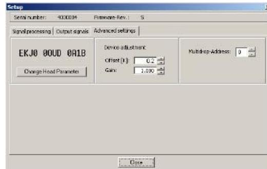
**Abb. 6-12: Erweiterte Einstellungen – Änderung der Messkopf-Parameter**
