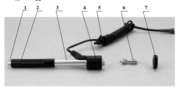
1 Auslöseknopf 2 Laderohr 3 Führungsrohr 4 Spulen-Bauteil
