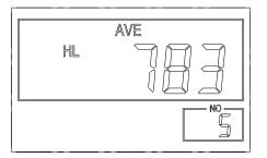
Testen sie an 5 Punkten an dem Standard-Testblock. Das Gerät wird nach 5 Messungen den Durchschnittswert anzeigen. Drücken sie ⊕ oder ➡ , um den nominellen Wert zu ändern.
