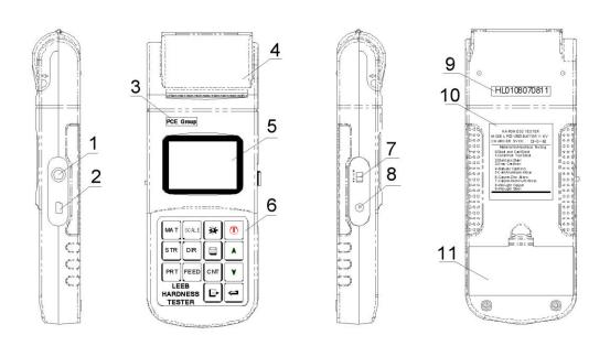
1 Anschlussdose für das Schlaggerät 2 Anschlussdose für den USB-Anschluss 3 LOGO 4 Abdeckung des Papierfaches 5 LCD Display 6 Tastatur 7 Akku-Schalter 8 Strom Anschlussdose 9 Seriennummer 10 Produktaufkleber 11 Abdeckung des Batteriefachs
