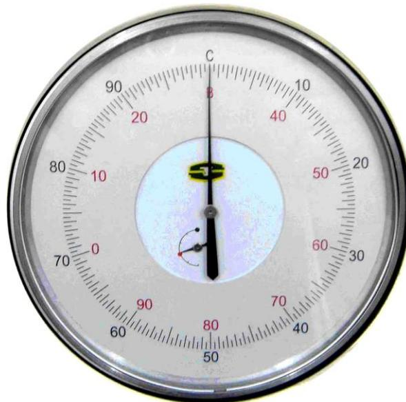
Lösen Sie mithilfe der Verriegelung an der rechten Seite des Gerätes die Gewichte und warten Sie, bis der Messzeiger sich stabilisiert hat (ca. 2 - 6s). Verriegeln Sie die Gewichte wieder. Sie können das Messergebnis jetzt ablesen. Für die Härtegrade HRA und HRC nehmen Sie die schwarze Skalierung (gekennzeichnet mit C) und für den Härtegrad HRB nehmen Sie die rote Skalierung (gekennzeichnet mit B). Drehen Sie das Handrad, bis Sie die Probe entnehmen können.
