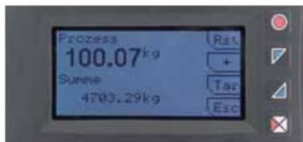
Drücken Sie **Summenfunktion**, um auf die Seite der Summenfunktion zu gelangen. Wenn Sie **+** drücken, dann wird der **Prozesswert** der Summe hinzugefügt. Wenn Sie **Rst** länger drücken, können Sie den Summenwert zurücksetzen, zum Tарieren des Prozesswertes drücken Sie **Tar**.
