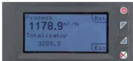
Auf der entsprechenden Anzeige ist es möglich, den Messwert und den integrierten Wert anzuzeigen. Über das Drücken von **Rst** kann man den integrierten Wert zurücksetzen.
