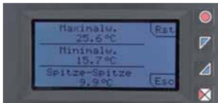
Die UA964801 stellt eine Anzeige für die Visualisierung der Spitzenwerte zur Verfügung: Maximalw./Minimalw. und Spitze-Spitze des Analogeingangs. Durch Drücken von **Rst** werden die angezeigten Werte zurückgesetzt.
