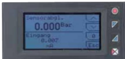
Zum Verwenden dieser Funktion gehen Sie in die Konfiguration und in das Menü des Analogeingangs, wählen **Einstellung** bei Parameter 8 **Sensorabgl.** und drücken **Sel** (UA964801 zeigt die Darstellung wie im Bild dargestellt).
