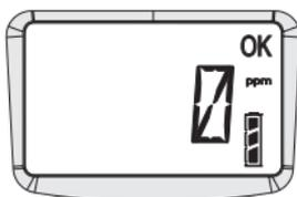
Der Sensorkanal zeigt den aktuellen Wert des überwachten Gases sowie die Maßeinheit an. Das Symbol „OK“ blinkt, um anzuzeigen, dass das Gerät korrekt funktioniert. Machen Sie sich mit dem Gas vertraut, das von Ihrem Gerät überwacht wird. Vergewissern Sie sich, dass Sie die Gesundheits- und Sicherheitsverfahren im Alarmfall ausführen können. Weitere Informationen zu Spitzen- und Zeitmittelwerten finden Sie in Abschnitt 2.4.
