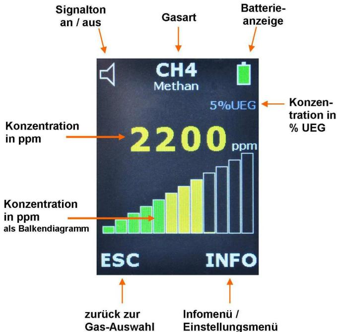
Die restliche Batterie- oder Akku- Kapazität wird bei über 50% mit einem grünen Batteriesymbol, zwischen 50% und 30% mit einem gelben und unter 30% mit einem roten blinkenden Batteriesymbol gezeigt. Bei nicht ausreichender Spannung schaltet das Gerät mit einem kurzen Hinweis ab.
