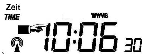
1. Eine Betätigung des Bereichs TIME ermöglicht die Einstellung des Displaykontrasts (0...8, Startwert ist 5) durch Drücken von + und –.
