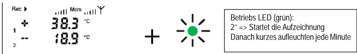
Das Display zeigt die Temperatur in Grad °C, Kanal Nummer, Messeinheit und Speicher Status. Die grüne LED leuchtet jede Minute.
