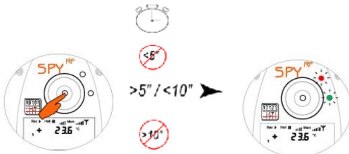
Um den Logger zu stoppen, muss zwischen 5 bis 10 Sekunden der Starter gedrückt werden
