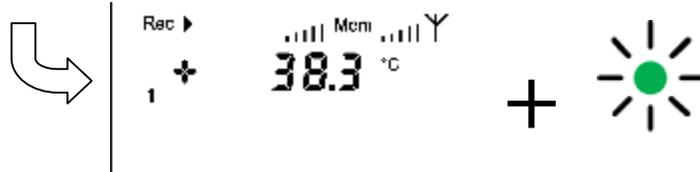
Das Display zeigt die Temperatur in Grad °C, Kanal Nummer, Messeinheit und Speicher Status.
