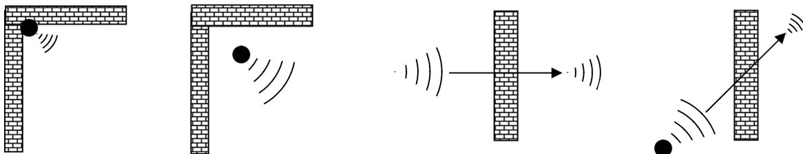
Das Signal kann durch Wände aus Vollmetall nicht hinausgelangen. Andererseits kann das Signal eine Metallverstrebt Wand unter Einschränkungen durchdringen.
