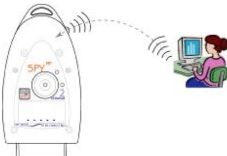
Die Konfiguration des Loggers SPY RF wird über die Software SIRIUS erstellt und dann über Funk an den Logger gesendet.
