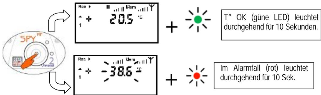
Diese Aktion der Überprüfung wird im Software Protokoll mit aufgeführt und bestätigt Ihnen Die Kontrolle der Temperatur durch eine Person.
