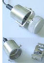
☞ Die Becherelektrode mit dem zu untersuchenden Material füllen und die Becherelektrode schließen.
