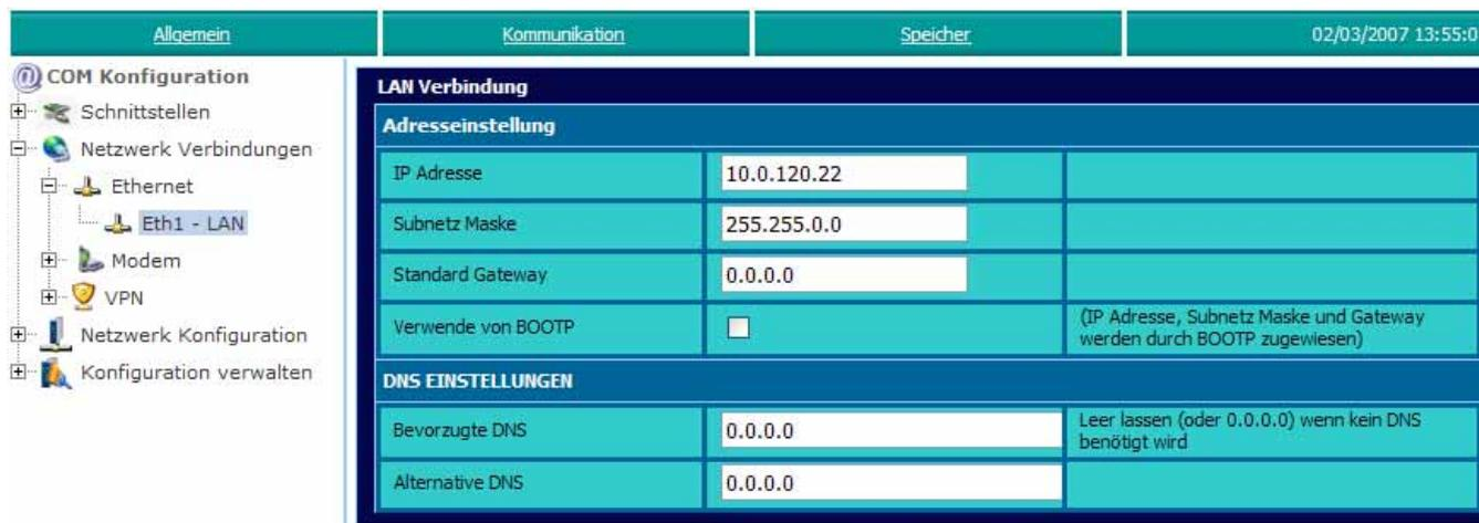
Figure 32: Netzwerk Verbindungen: Ethernet Einstellungen
