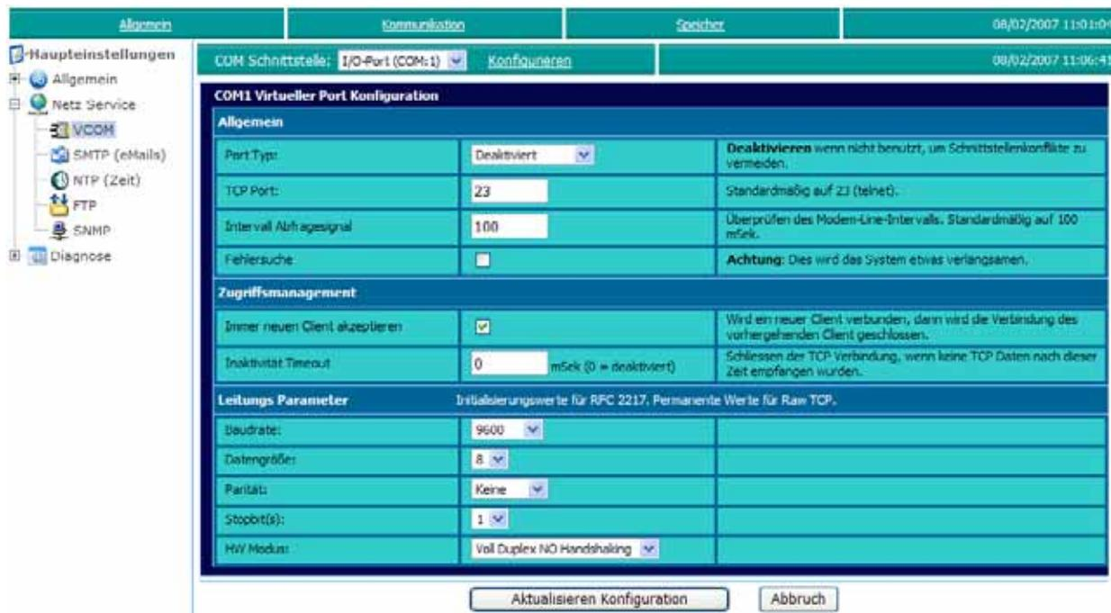
Figure 17: eWON Virtuelle COM Schnittstellenkonfigurationsseite
