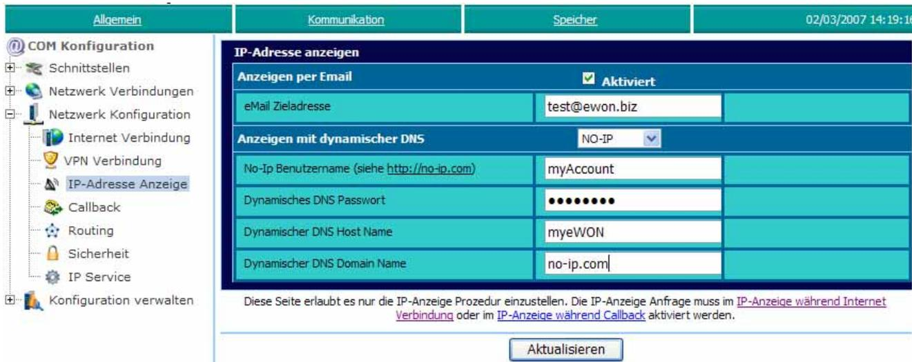
Figure 44: IP-Adresse Anzeigen Konfigurationsseite
