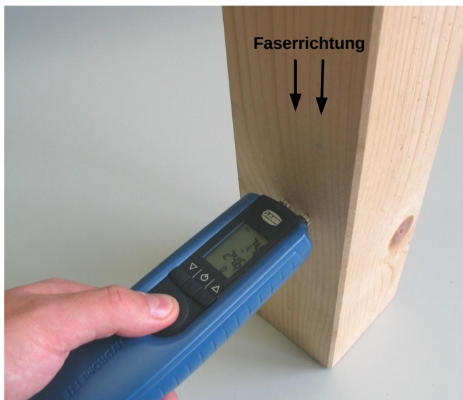
Abbildung 4-1 Messung quer zur Faserrichtung
