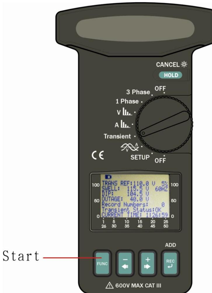
Nachdem Sie die FUNC Taste gedrückt haben wird die Anzeige geleert und die LED neben den Anschlussbuchsen fängt an zu blinken.
