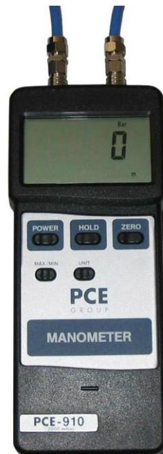
Mit den PCE -Digitalmanometern sind Sie in der Lage, den Differenzdruck zu messen. Die Manometer eignen sich hervorragend für die Bereiche Heizung / Lüftung / Klima (HLK), Hydraulik, Medizintechnik, Pneumatik- und Computerapplikationen sowie Labormessungen. Die Geräte können zur Messung flüssiger Medien verwendet werden – Ausnahme sind Säuren und Laugen sowie Gase, die Partikel von Säuren oder Laugen mit sich führen.
