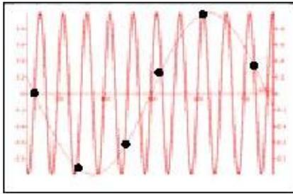
Abbildung 6: Frequenzverzerrung
