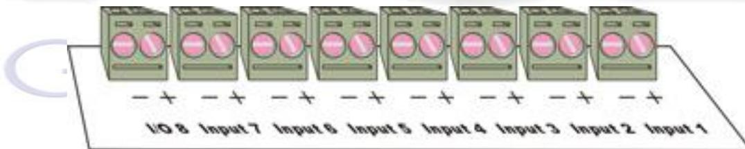
Abbildung 2: Eingangs-Klemmenblock des DAQPRO
