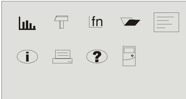
Der DAQPRO hat 9 Menüs. Markieren Sie ein gewünschtes Menü mit den **Vorwärts- oder Rückwärts**-Tasten und drücken Sie die **Enter**-Taste, um es zu öffnen. Durchlaufen Sie die Menüoptionen mit den Pfeiltasten **Vorwärts oder Rückwärts** und drücken Sie die **Enter**-Taste, um eine Option auszuwählen. Der DAQPRO führt daraufhin den entsprechenden Befehl aus.
