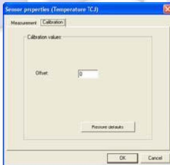
Der Offsetwert ist die Differenz zwischen dem Referenzwert und dem Wert, den der DAQPRO anzeigt. Wenn der Kalibrator zum Beispiel auf 0°C eingestellt ist und der DAQPRO 1°C anzeigt, beträgt der Offsetwert +1. Zeigt der DAQPRO dagegen -1°C, beträgt der Offsetwert -1.
